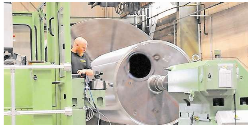
Die Zylinderfertigung erfolgt bei Krafft mit CNC-Technik.
