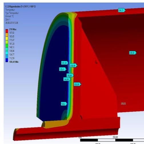
Mit der #ESD reduzieren wir diese Verluste an den Zylinderstirnseiten signifikant. Die Energie des Hochdruckdampfes bleibt im Zylinder und fließt nicht in die Umhausung ab. Warme Luft in der Haube haben Sie im Regelfall genug. Wir laden Sie ein, zu einer:
